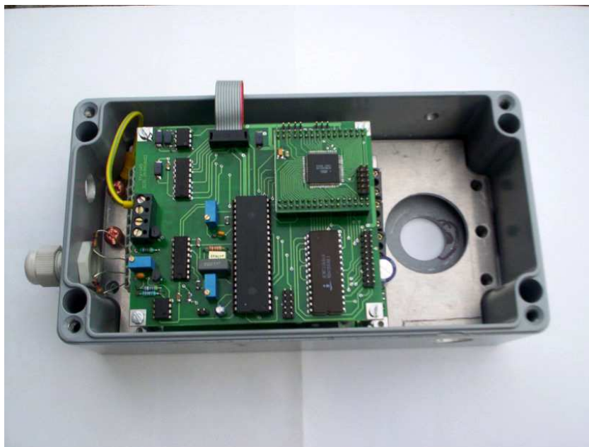
Foto. 3.1. Widok wnętrza obudowy ME analizatora CAT 7.
